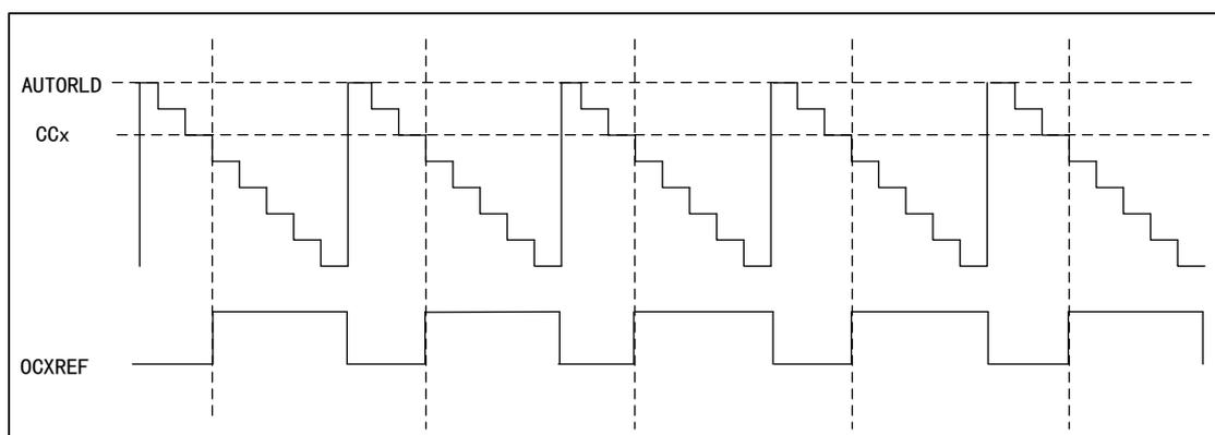
图 31 PWM1 中央对齐模式的时序图
