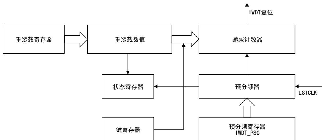
注：看门狗功能处于 V<sub>DD</sub> 供电区，可以在停机或者待机模式下正常工作。
