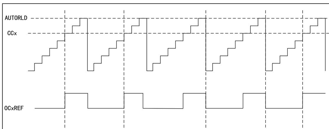
图 33 PWM2 向下计数模式的时序图
