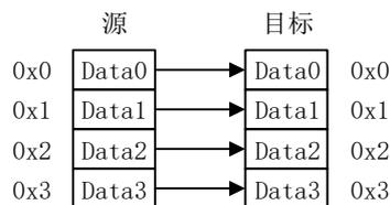
图 12 源为 8bits 目标为 16bits 的传输宽度
