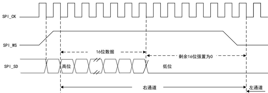
在发送过程中，要将 MSB 写入寄存器 SPI\_DATA，在 TXBEFLG 标志位置 1 时可以写入新数据；如果有相应的中断，可以产生中断。
