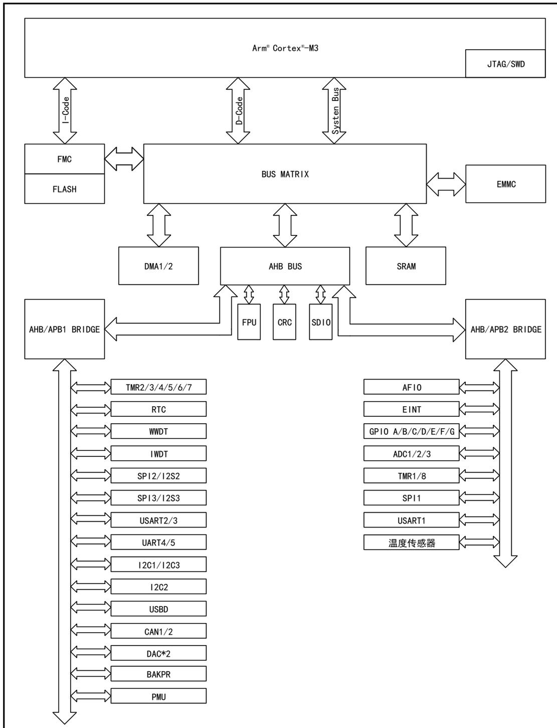
图 2 APM32E103VET6S 系统架构框图
