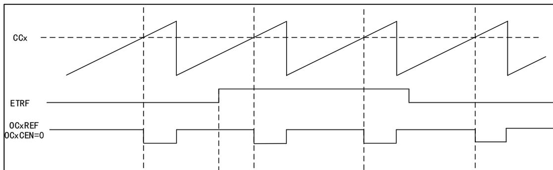
将 TMRx 置于 PWM 模式，关闭外部触发预分频器，禁止外部触发模式 2，当 ETRF 输入为高时，通过设置 OCxCEN=1，输出的 OCxREF 信号如下图。
