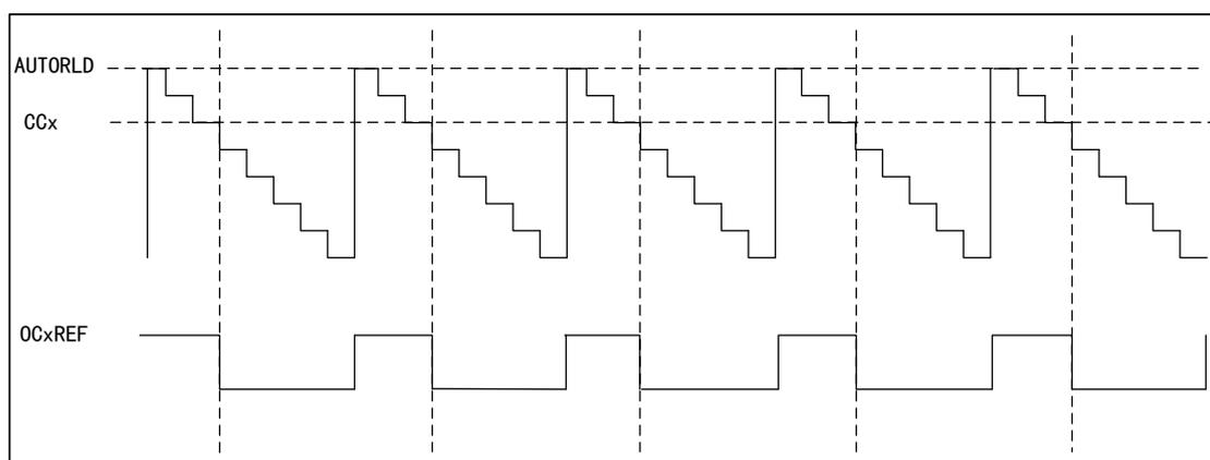
图 34 PWM2 中央对齐模式的时序图
