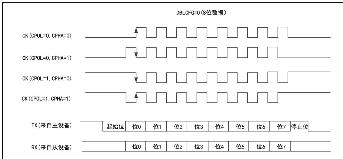
图 71 USART 同步传输时序图 (DBLCFG=1)
