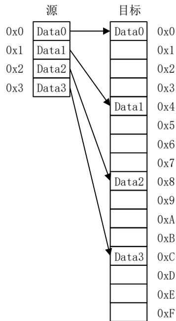
图 14 源为 32bits 目标为 8bits 的传输宽度
