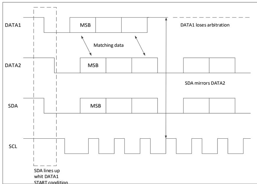
对于高速模式，因为每个主机都用一个唯一的高速主代码编程，仲裁不能进入数据阶段。这个 8 位代码由系统设计者定义，并通过写入高速主模式代码地址寄存器 HSMC 进行设置。由于这些码是唯一的，只有一个主码才能赢得仲裁，这发生在高速主码传输结束时。总线的控制由地址或主代码以及竞争主机发送的数据决定，因此总线上既没有中央主机，也没有任何优先级顺序。
