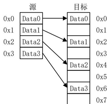
图 13 源为 8bits 目标为 32bits 的传输宽度
