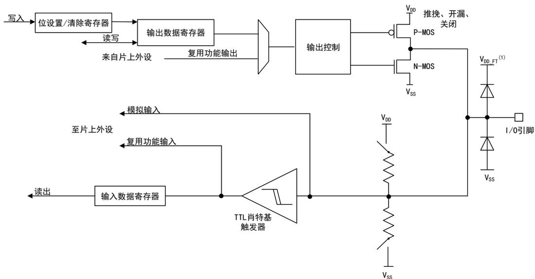
(1)  $V_{DD\_FT}$  和  $V_{DD}$  不一样， $V_{DD\_FT}$  对 5 伏容忍 GPIO 引脚是特殊的。
