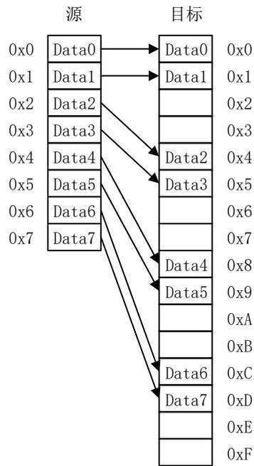
图 17 源为 32bits 目标为 16bits 的传输宽度
