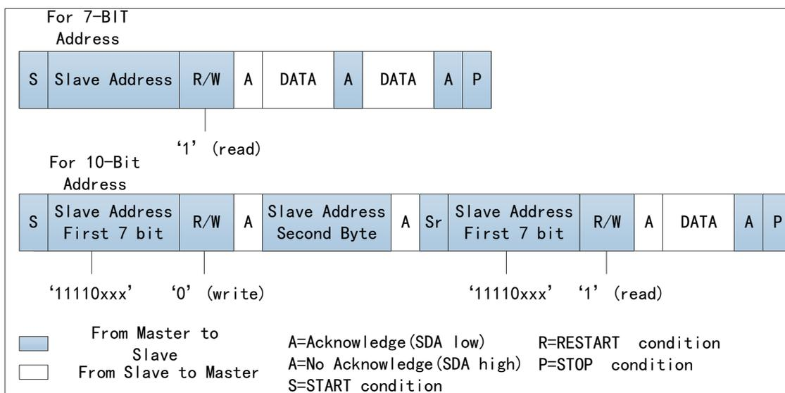
从发送器在检测到无应答（NACK）后放弃 SDA 线路，以便主发送器可以发出停止条件。这与启动条件相同，只是发生在 ACK 脉冲之后。在主模式下运行时，I2C 可以使用不同方向的传输与同一从机通信。
