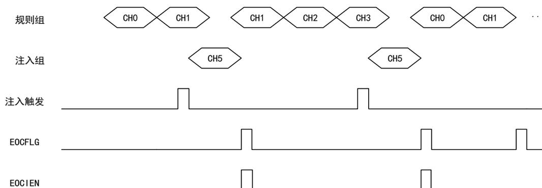
自动注入：需要配置寄存器 ADC\_CTRL1 的 INJGACEN 位启动，在规则组通道转换完成后，注入组通道自动开始转换，自动注入模式下，注入组通道的外部触发必须禁止；若还配置了寄存器 ADC\_CTRL2 的 CONTCEN 位，规则组和注入组的所有通道按序列进行连续转换。
