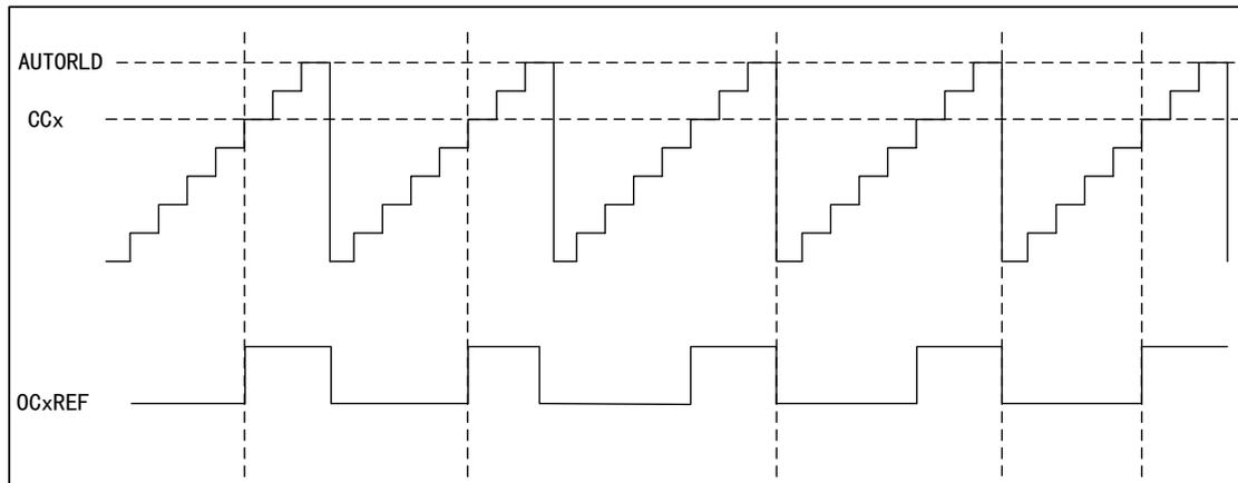
图 53 PWM2 向下计数模式的时序图
