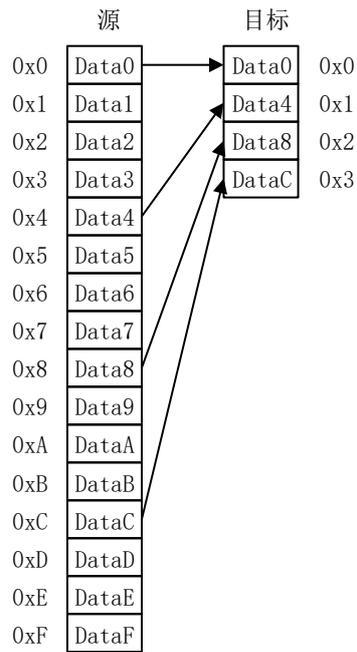
图 15 源为 16bits 目标为 16bits 的传输宽度
