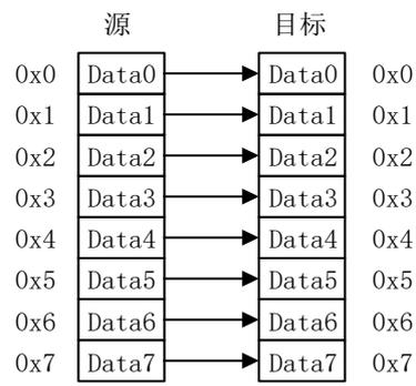
图 16 源为 16bits 目标为 32bits 的传输宽度
