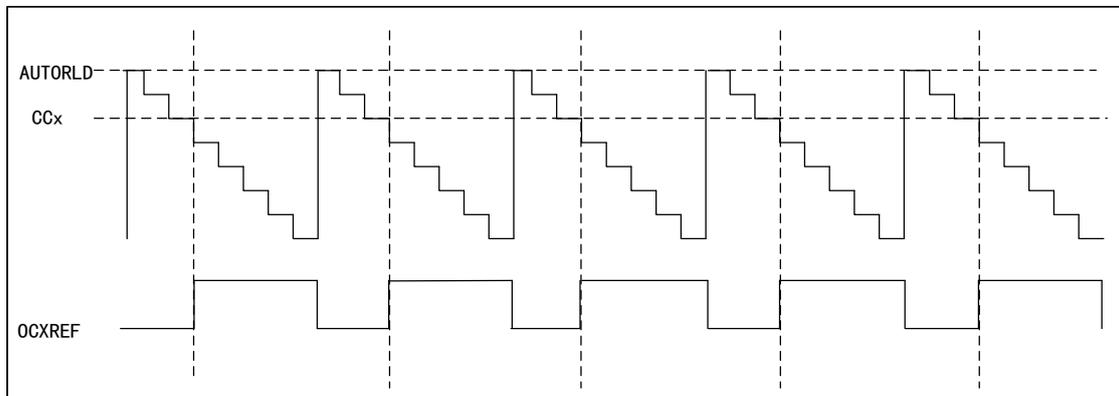
图 51 PWM1 中央对齐模式的时序图
