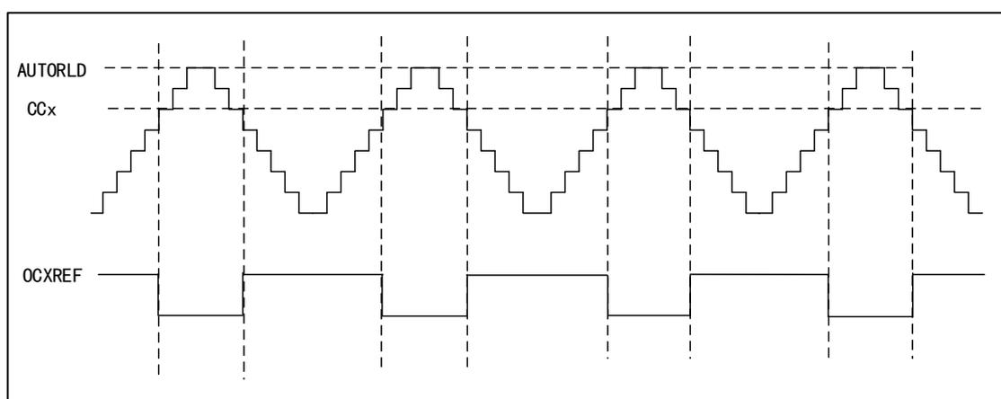
PWM 模式 2 中如果计数器 CNT 的值小于比较寄存器 CCx 的值，输出无效电平，否则反之。
