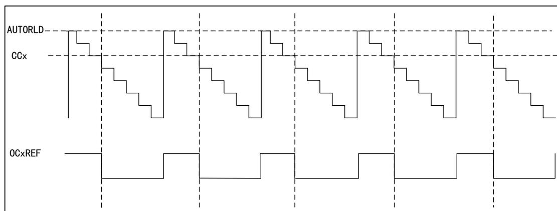
图 54 PWM2 中央对齐模式的时序图
