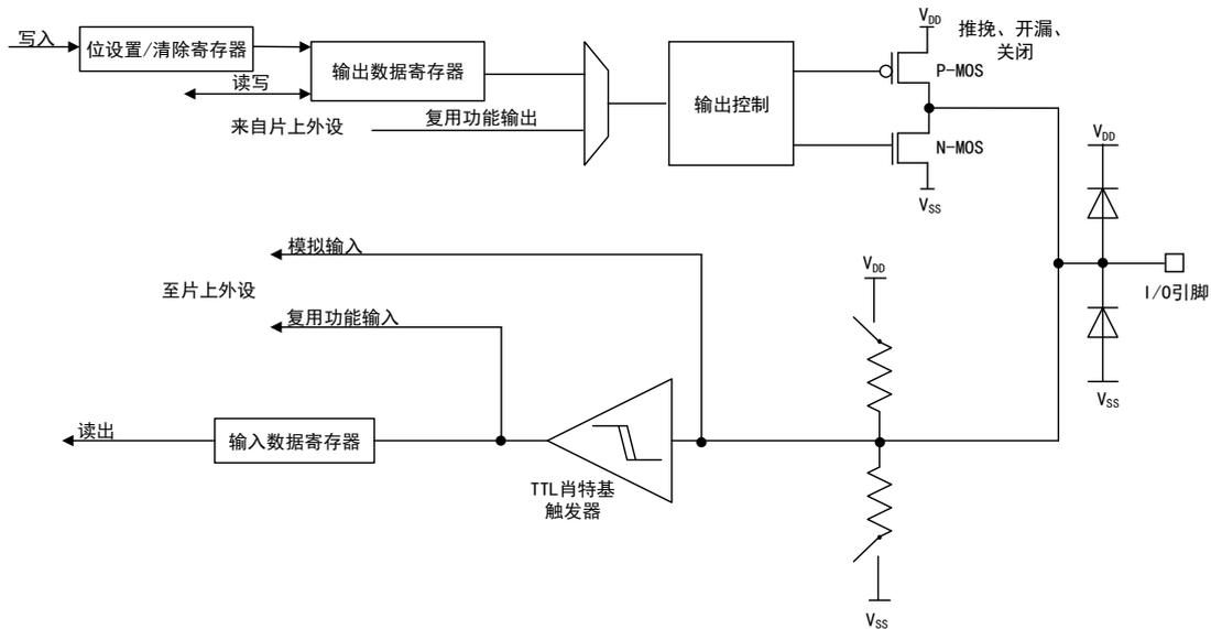
图 20 5 伏兼容 GPIO 结构框图
